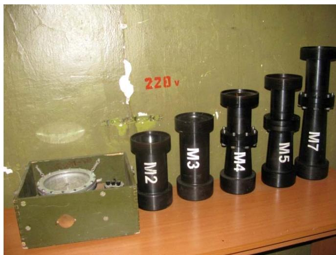
Рис. 2. Сверхзвуковые сопла
