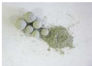
Рис. 3. Шарики шаровой мельницы с образовавшимся на них покрытием
