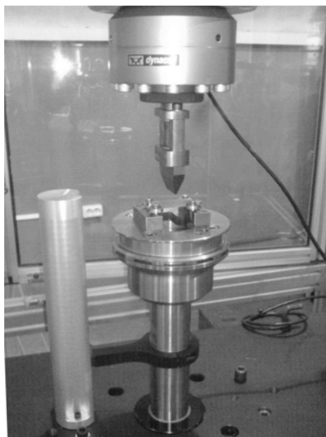
Рис. 1. Приспособление для нагружения образцов на сервогидравлическом стенде Instron VHS 40/50-20
