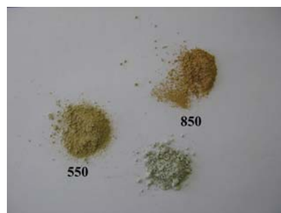
Рис. 2. Изменение цвета порошка серпентина при нагреве его в воздушной атмосфере до 550 и 850 °С
