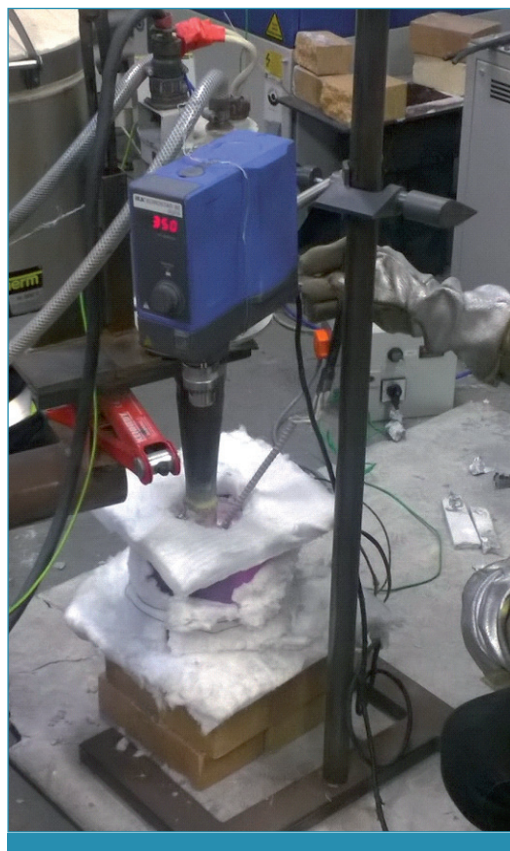
Рис. 2.30. Процесс введения лигатур в расплав алюминиевого сплава с использованием ультразвуковой обработки
